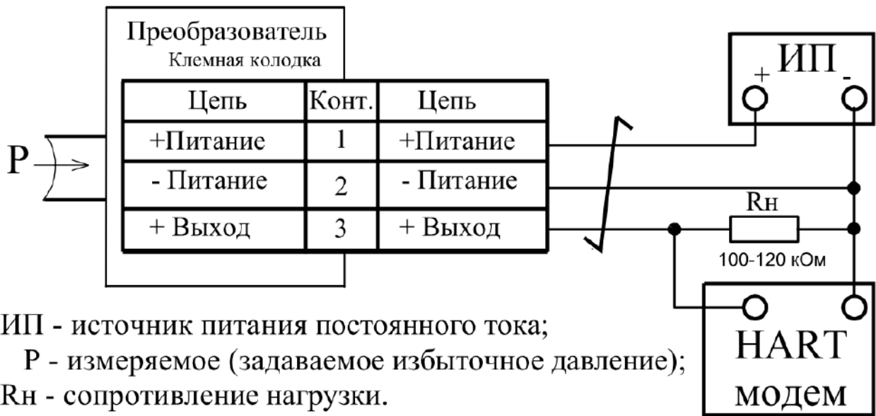
Рисунок В.4 — Схема подключения HART® модема к преобразователям
